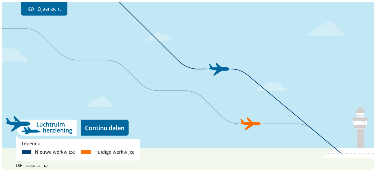
Figuur 2: Zijaanzicht met huidige werkwijze van trapsgewijs naderen via vectoren en nieuwe werkwijze middels continu dalen over vaste naderingsroute. Schets is indicatief en niet op schaal.
