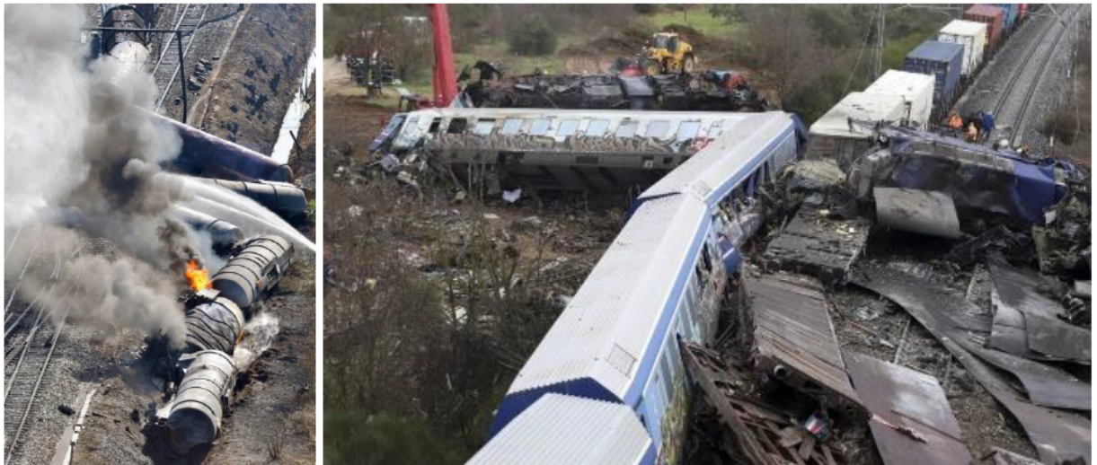
Figuur 6.6 Ontsporing naast het ballastbed. Links: Wetteren, 2013 en rechts: Larisa, 2023
