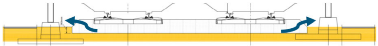
Uitstroming uit ballastbed bij dubbelsporige spoorbaan met lager gelegen inspectiepaden
