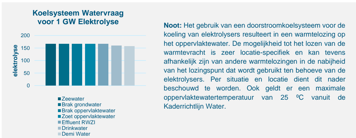
Figuur 3-8: Grafische weergave van de watervraag per waterbron voor gebruik in doorstroomkoelsystemen
