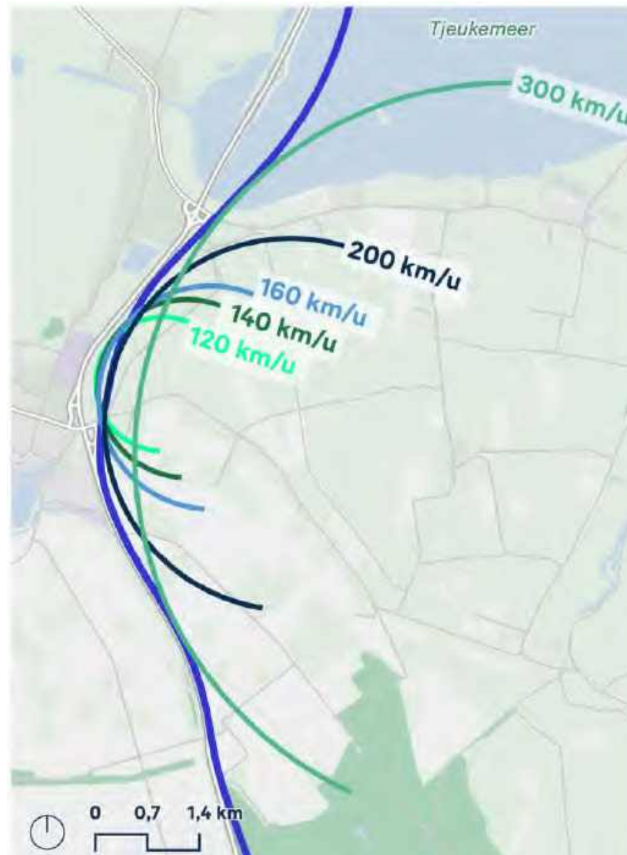
Figuur 66. Voorbeeld boogstralen voor verschillende snelheden bij Lemmer.
