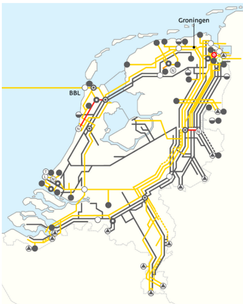
Figuur 4.13 Transmissienetwerk voor hoogcalorisch gas (geel) en Groningen gas (zwart) (Bron: GTS, 2023)
