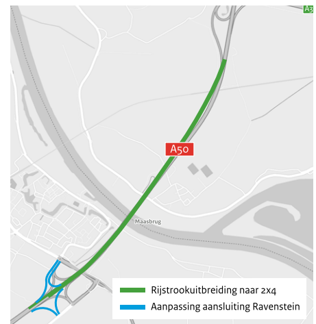
Figuur 12: Rijstrookuitbreiding naar 2x4
