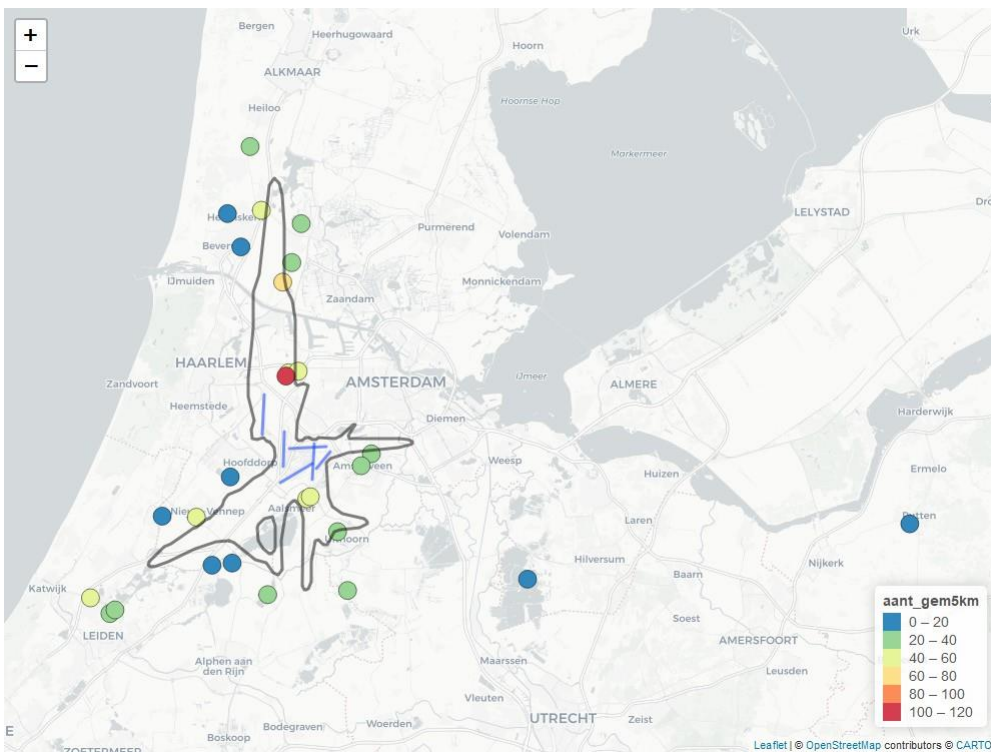
Figuur 7.4.3 Indicator aantallen onder 5 kilometer op de kaart. Per dagdeel is voor elke locatie het aantal passages met vlieghoogte onder 5 kilometer bepaald. Voor elke locatie is hiervan het gemiddelde weergegeven.
