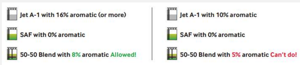
Figuur 2-1 Toegestane mengverhoudingen voor Jet A1 met SAF om te voldoen aan de gestelde norm in ASTM D1655 brandstof specificatie (Aerospace Technology Institute, 2022)
