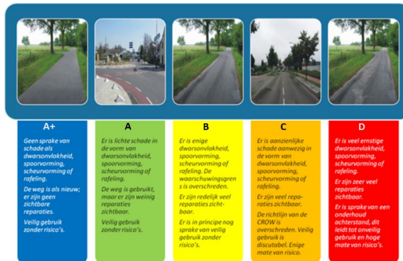
Figuur 3.4 Meetlat asfaltverharding
