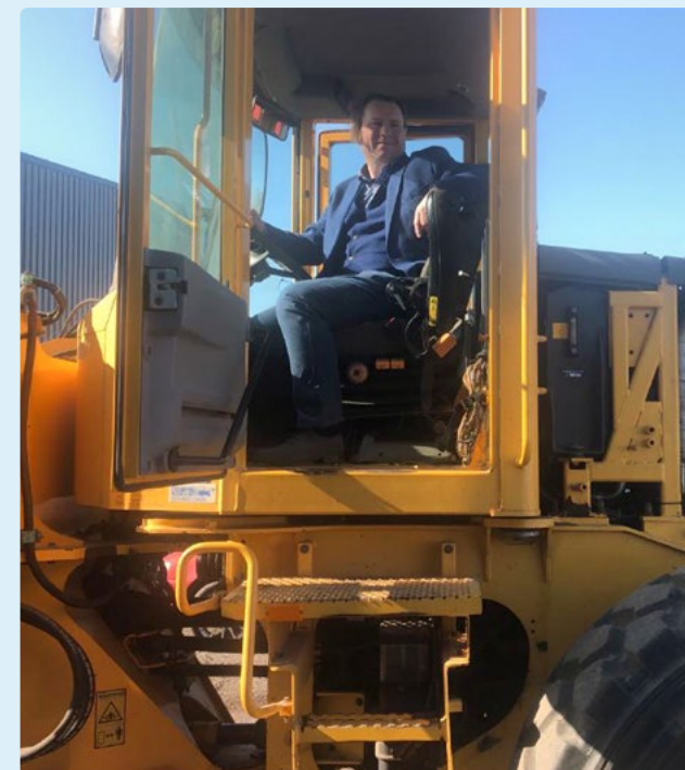
Wilko Wisse op een shovel/laadschop met gas brandstofmotor speciaal voor biogas.
