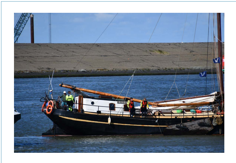
Figuur 3: De Risico vaart de haven van Harlingen binnen met de gebroken giek aan dek. (Bron: ANP)
