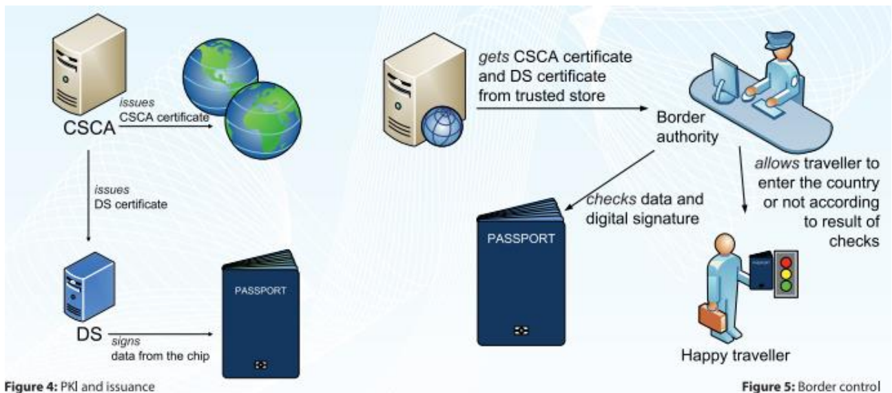
Figuur 9 Weergave van de wijze waarop gegevens in een eMRTD worden ondertekend (links) en worden uitgelezen (rechts) (bron afbeelding: [icao.int])
