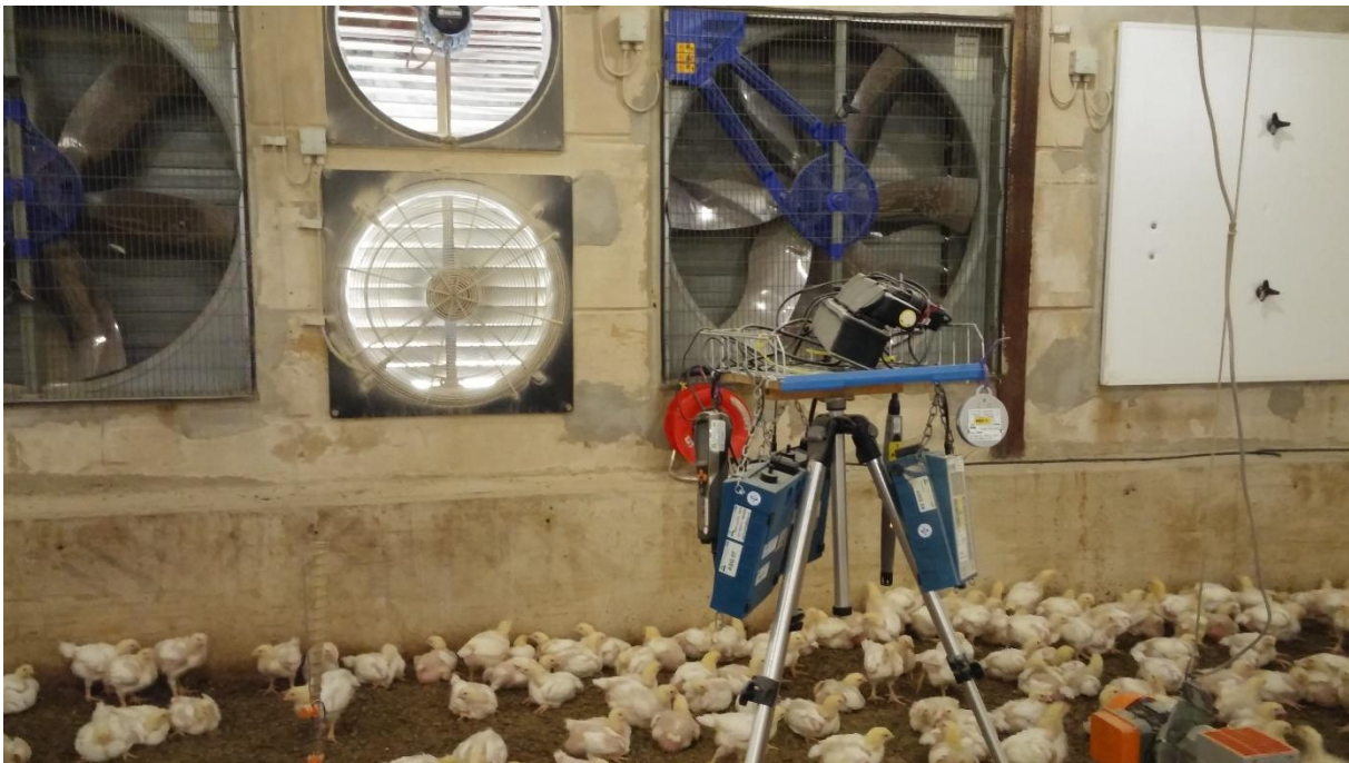
Figuur 3 Meten van de fijnstofconcentratie in een vleeskuikenstal, foto PEV
