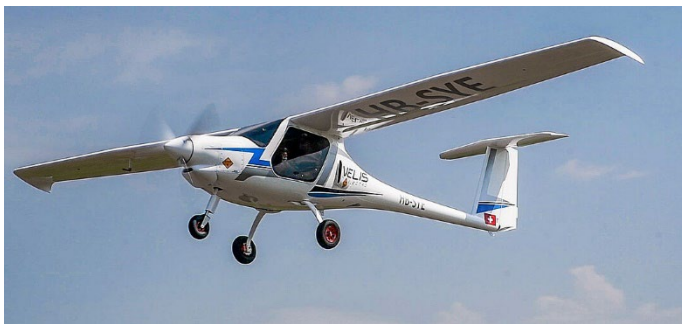
Pipistrel Velis Electric: operationele elektrische tweezitter
