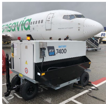
eGPU verzorgt stroom voor stationair vliegtuig zonder emissie
