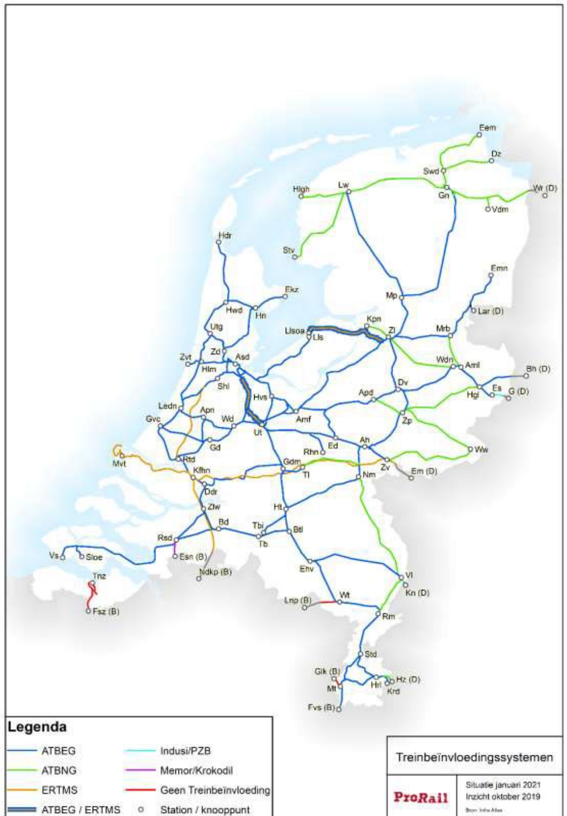
Figuur C.2: Overzichtskartaal van de treinbeïnvloedingsystemen op het hoofdspoor. Uit: ProRail. Netverklaring 2021 . Versie 1.4. Maart 2021, Bijlage 14.
