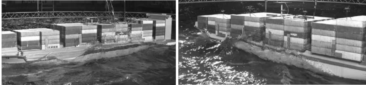
Voorbeelden van groenwater impacts in dwarsgolven (links) en schuin-achterinkomende golven (rechts)
