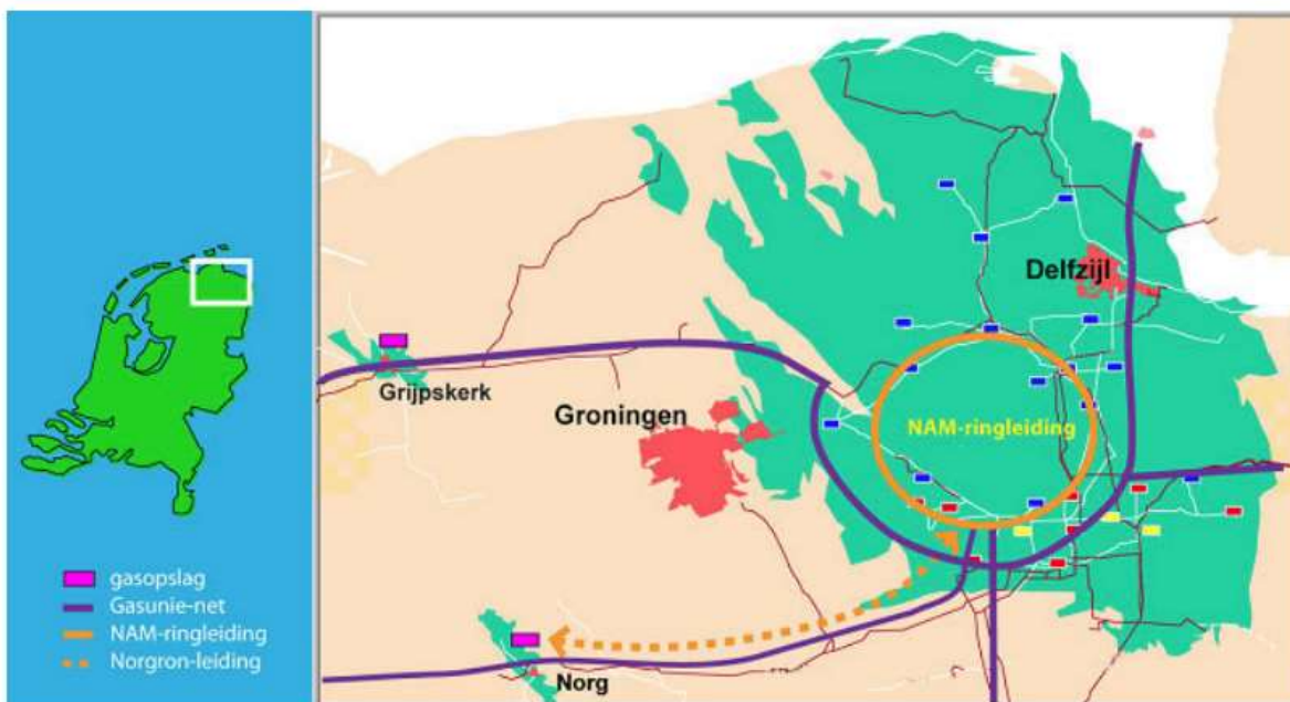
Figuur 3: Pijpleidingen naar de gasopslag Norg 12
