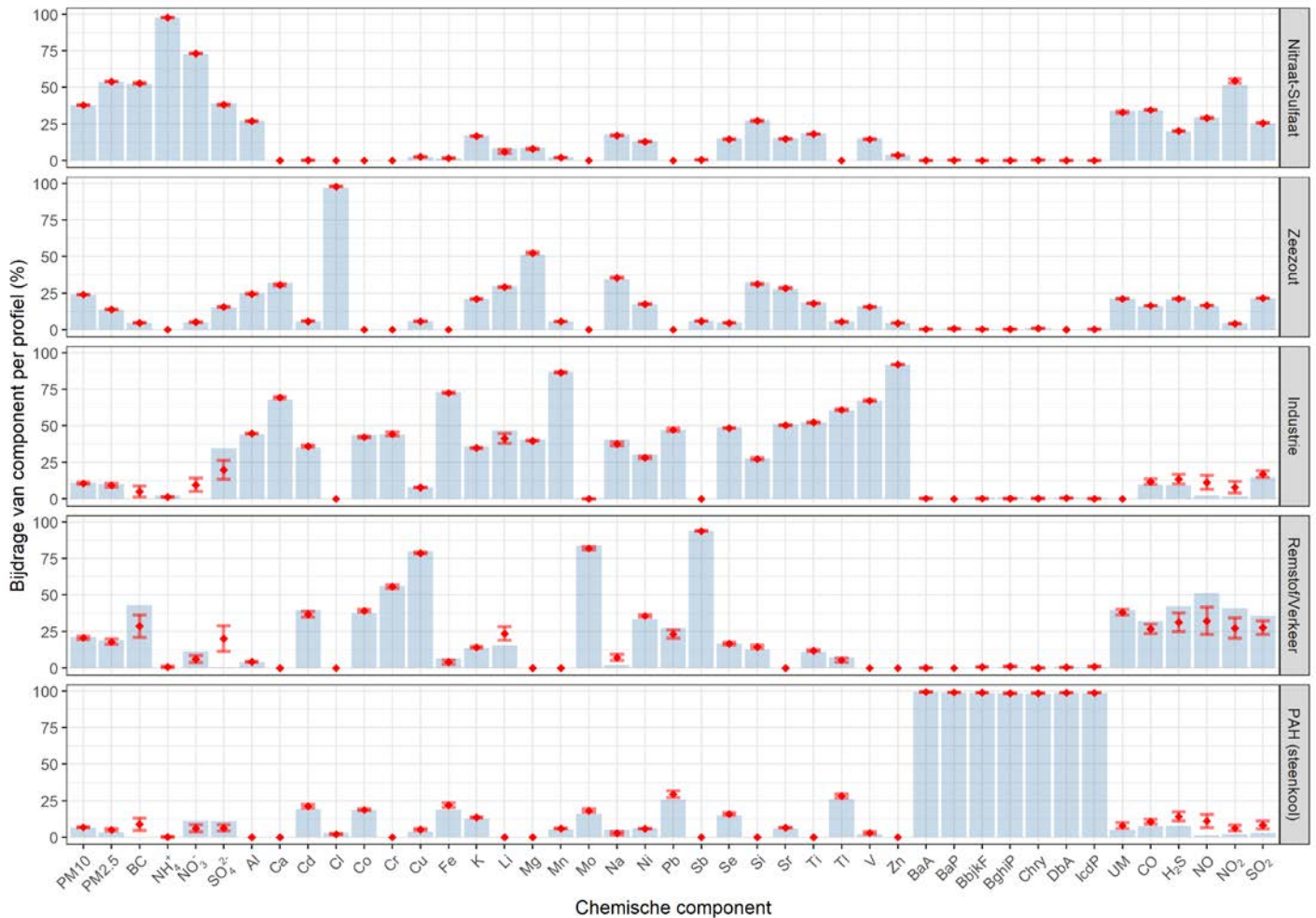
Figuur 4.10 Stabiliteit van de oplossing (WAZ). De blauwe balkjes zijn de bijdrage van de componenten per profiel voor de oplossing met de laagste Q-waarde. Het rode puntje geeft het gemiddelde aan van de 24 profielen met de daarop volgende laagste Q-waarde. De marges die worden weergegeven zijn het 95% betrouwbaarheidsinterval, waarbij waarden < 0 op 0% zijn gesteld. De figuren voor IJM en BEV zijn opgenomen in Bijlage 1
