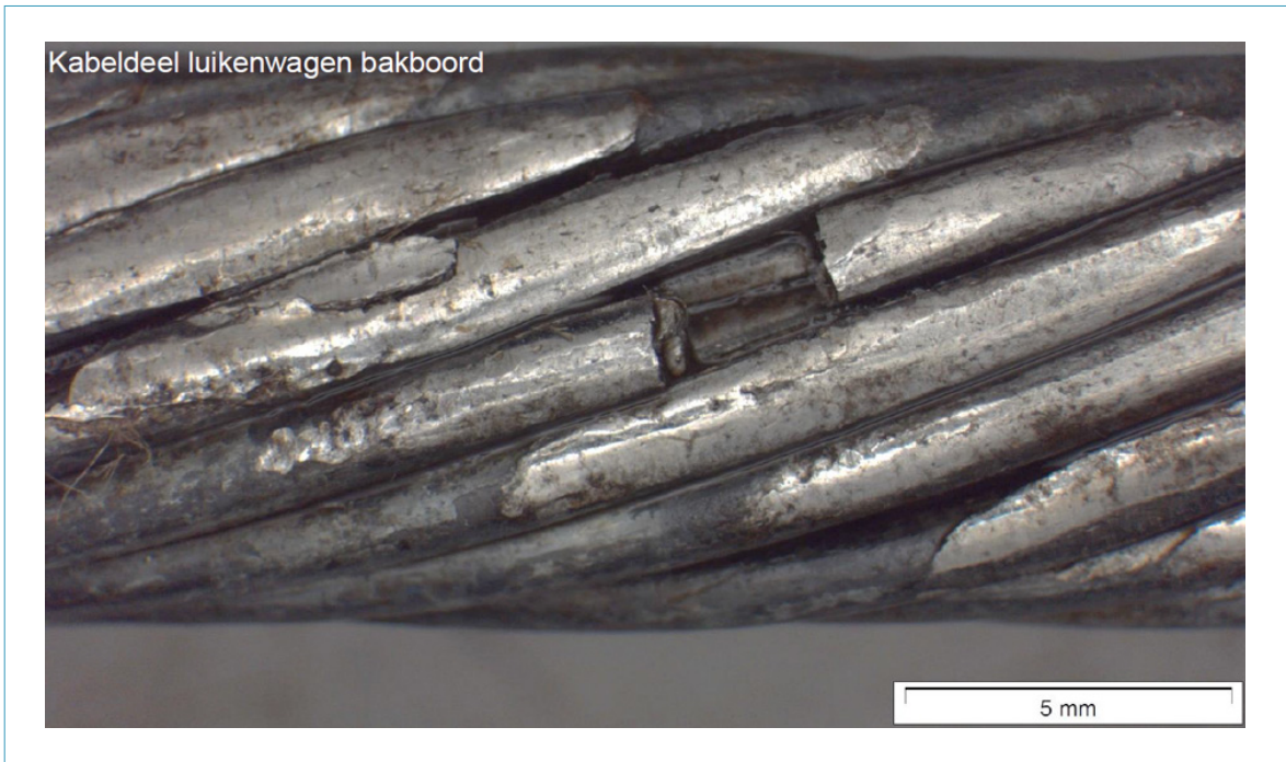
Figuur 9: Een foto uit het EMT-rapport. De brede beschadigingen op de strengen van de bakboord kabel, aan de luikenwagen zijde van de breuk, hebben een versmeerd uiterlijk waarbij sommige draden zijn gebroken. (Bron: Element Materials Technology)
