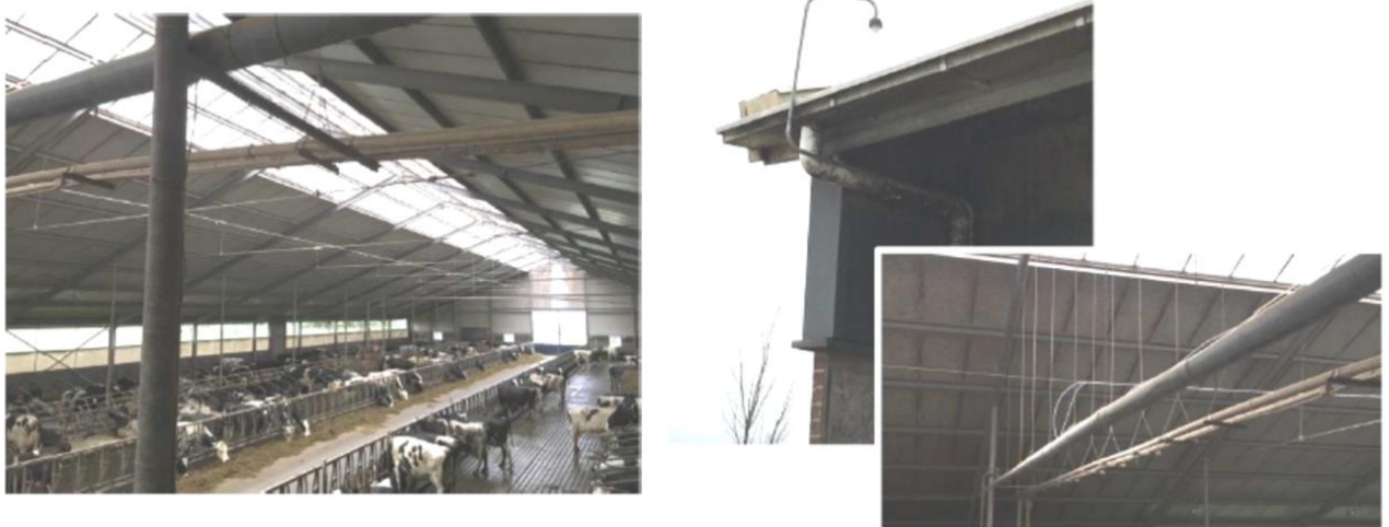
Figuur 4: De rechter en linker foto laten een voorbeeld van de monstername-leiding in de stal zien. De middelste foto laat een voorbeeld van een buitenmeetpunt zien.
