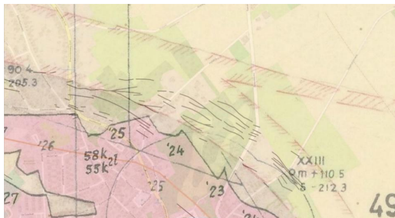
Figuur 10. Contouren van de Heerlerheidebreuk bij Oirsbeek-Amstenrade met aan het oppervlak drempels (zwarte losse lijnen) en aan zuidkant, in de ondergrond (roze vlakken) winningen van steenkool tot aan de breuk. Ten noorden van deze Heerlerheidebreuk heeft ook winning plaatsgevonden. Dit heeft tot de intensieve scheuren en drempels aan het oppervlak geleid.
