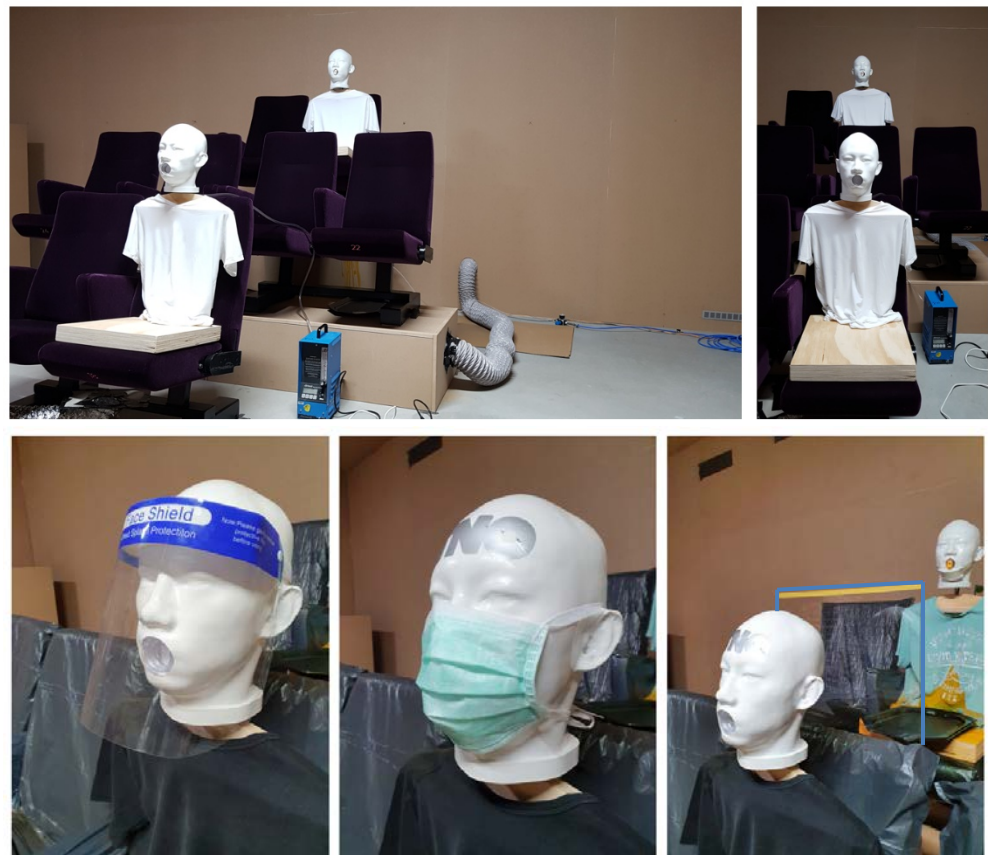
Figuur 6. Impressie van meetopstelling met vrijgehouden tussenrij en de verschillende maatregelen die zijn onderzocht (van links naar rechts: face shield, mond-neusmasker en stoelscherm).
