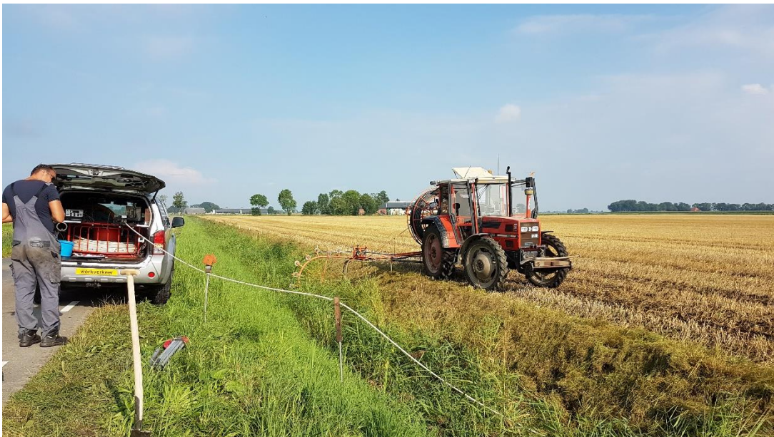
Fig. 2.6. Meting vlakteligging drainage augustus 2020 en trekker met drainreiniger die de drain vooraf spoelt
