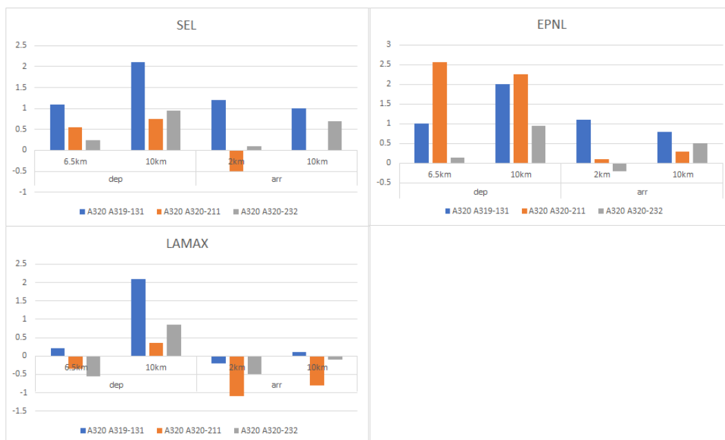
Figuur 26: Verschil in SEL, EPNL en LAMax voor de Airbus A320 familie na toepassen geluidcorrectie.
