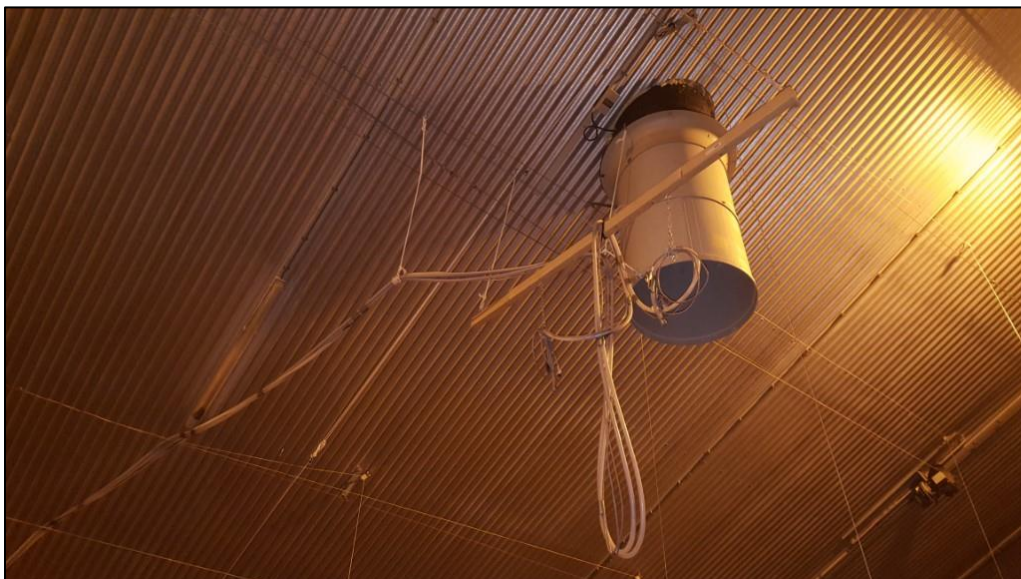
Oplierbare balk met monsternameleidingen en ophangpunten voor meetapparatuur
