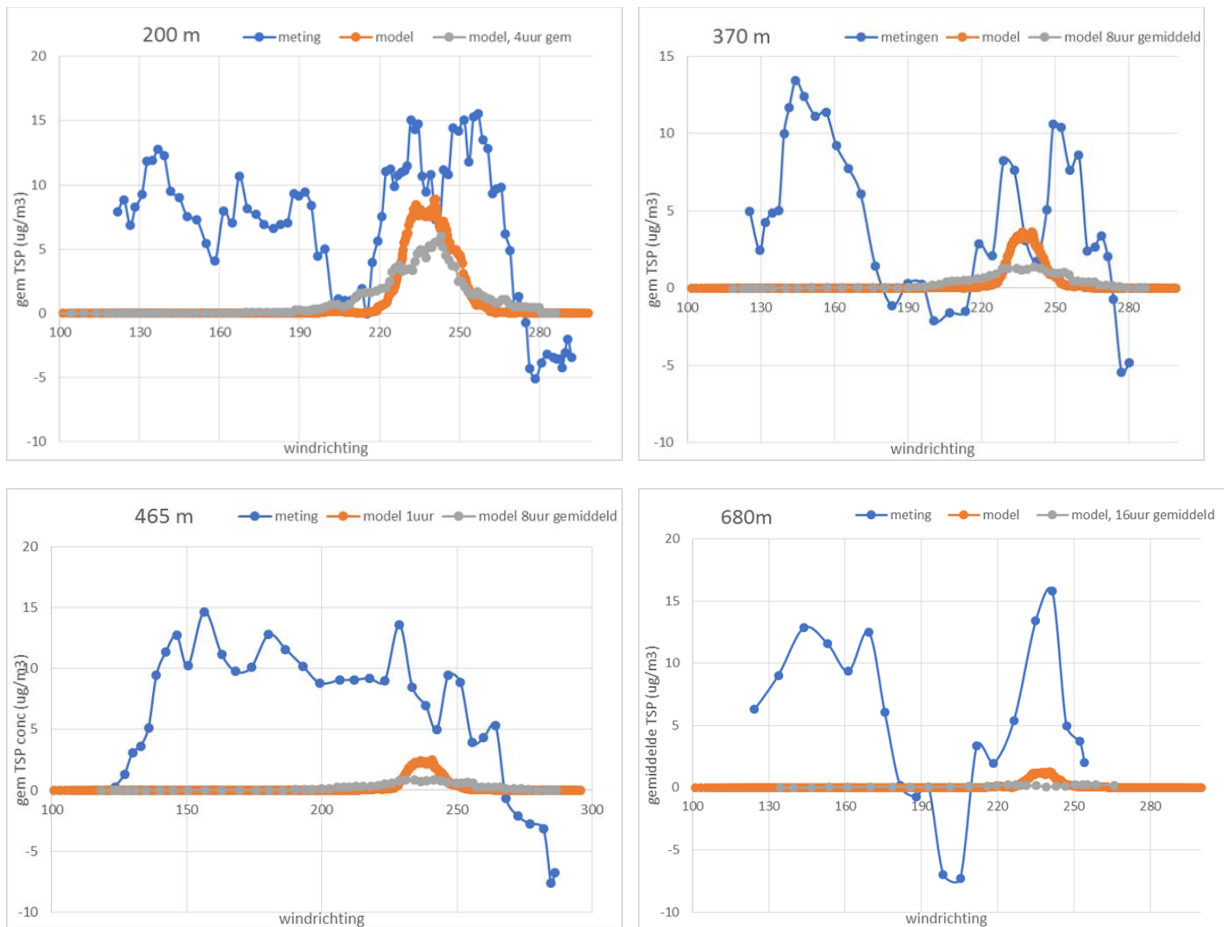
Figuur 3.8 Windroos van gemeten (blauw) en berekende (oranje, grijs) TSP concentraties op 200, 370, 465 en 680 m benedenwinds van de stallen. Oranje: uurgemiddelde modelwaarden; grijs: 4- tot 16-uursgemiddelde modelwaarden. Van de gemeten concentraties is arbitrair 20 \mu\text{g}/\text{m}^3 afgetrokken (als geschatte achtergrond); dat maakt het plaatje beter vergelijkbaar (het gaat immers om het patroon).
