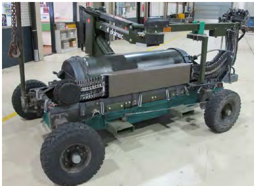
Figuur 3 Voorbeeld van een Linkless Ammunition Loading System (bron: DMO).
