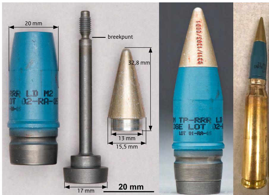
Figuur 2 Voorbeeld van de gebruikte 20 mm munitie. Linker afbeelding: de samenstellende delen; van links naar rechts het kogellichaam, de metalen pin en de aluminium kogelpunt. Middelste afbeelding: de kogel. Rechter afbeelding: het patroon, ofwel de kogel inclusief huls (bron: NLR).
