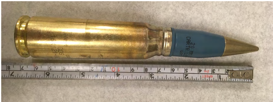
Figuur 15 Voorbeeld van beschadigde munitie. De patroon is verbogen en de huls van de patroon heeft diverse beschadigingen bij de flensrand (bron: IVD).
