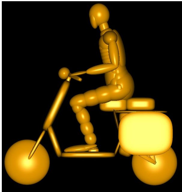
Figuur 5 Model van bestuurder en snor/bromfiets zoals gebruikt in de simulatiestudies.
