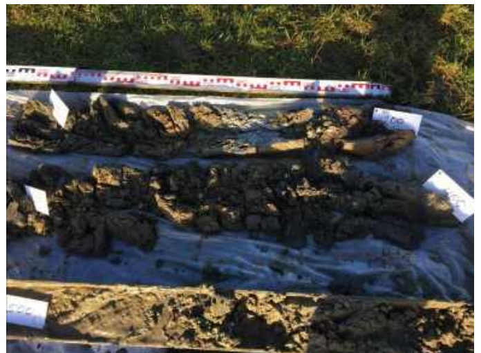
Foto 28 - Plaatsing peilbuis 103 (1 - 6 m-mv)
