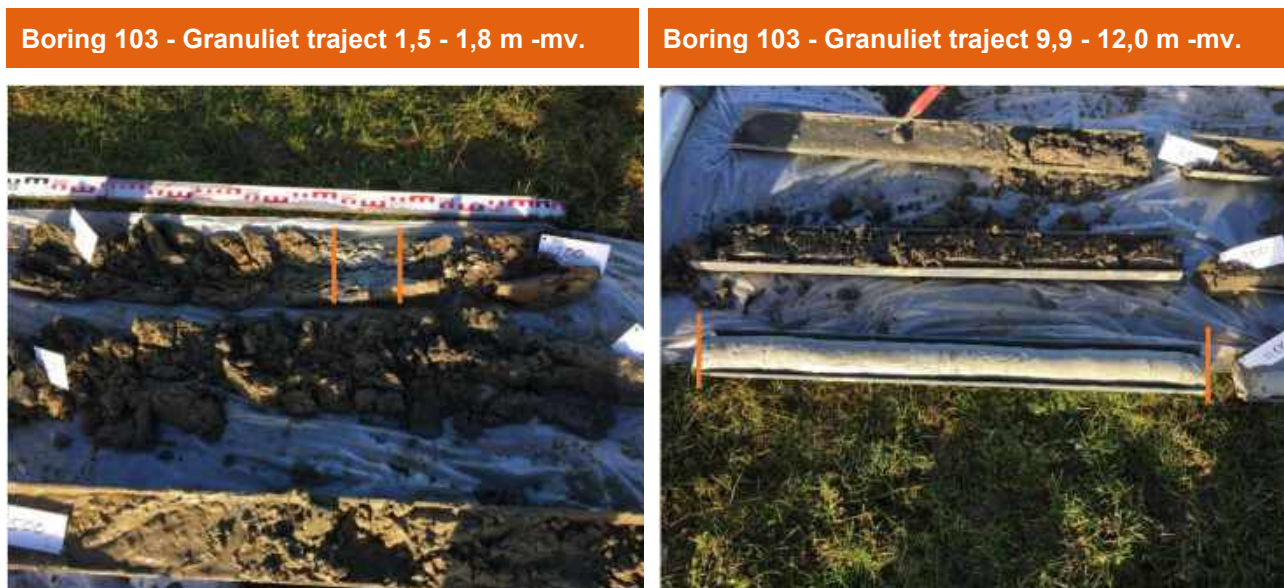
Figuur 7 - Visuele waarneming granuliet (grijze kleur). Links klei met resten granuliet binnen traject 1,5-1,8 m -mv. Rechts aaneengesloten laag granuliet binnen traject 9,9-12,0
