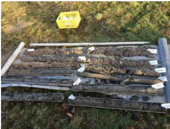
Foto 25 - Plaatsing peilbuis 102 (0 - 12 m-mv)
