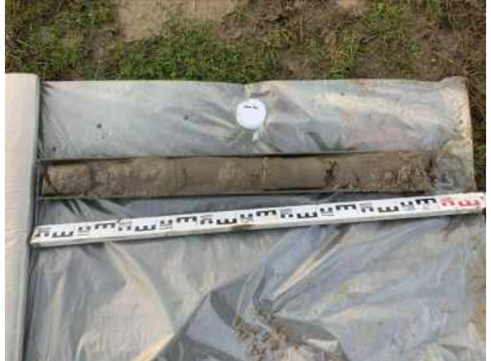
Foto 16 - Plaatsing peilbuis 101 (5 - 6 m-mv)
