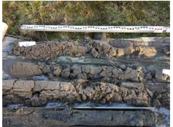
Foto 22 - Plaatsing peilbuis 102 (0 - 7 m-mv)
