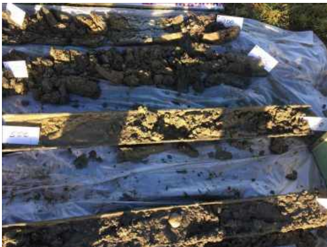
Foto 27 - Plaatsing peilbuis 103 (1 - 6 m-mv)
