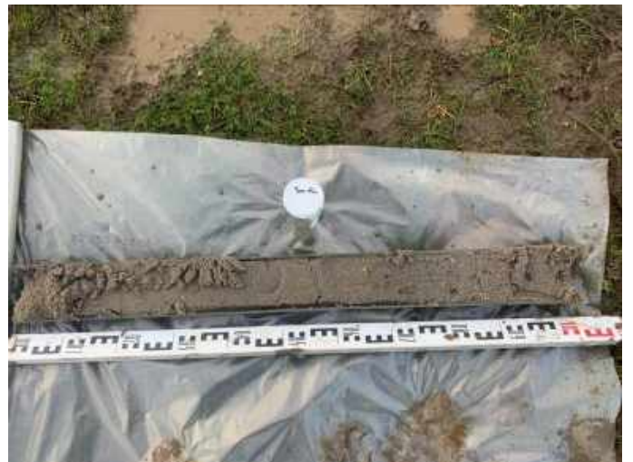
Foto 18 - Plaatsing peilbuis 101 (7 - 8 m-mv)
