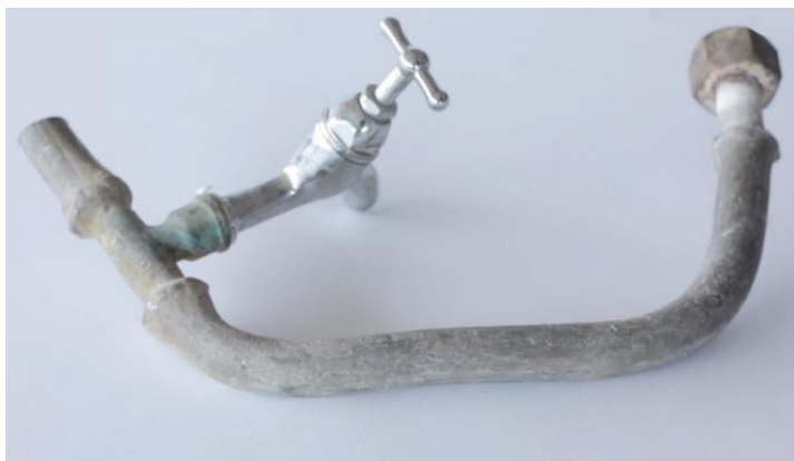
Figuur 3 : Loden leiding (bron: Drinkwaterplatform)
