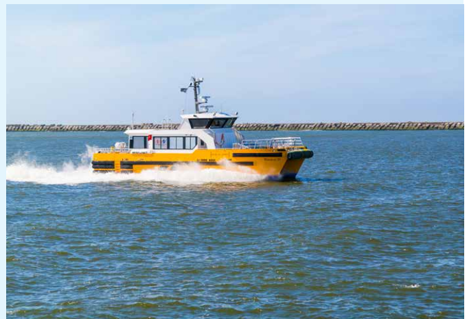
Figuur 7: Een windcat crew transfer vessel, zoals voor Vattenfall ontwikkeld zal worden aangedreven op waterstof
