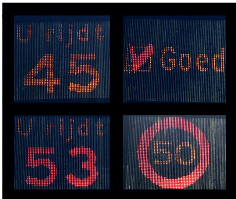
Figuur 29: Borden die door middel van radar automatisch de snelheid meten, hierover terugkoppeling aan de automobilist geven en een logbestand van gemeten snelheden bijhouden.
