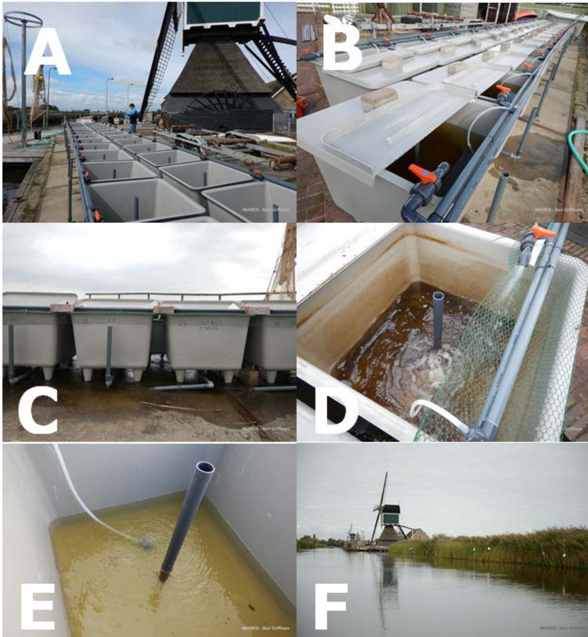
Figuur 2-2 De opstelling (A) van de 27 overlevingstanks (27 groepen vis incl. negen controle groepen). De bakken worden individueel aangevuld met hetzelfde kanaal water. De bakken hebben allemaal hun eigen afvoerpijp (C) en een eigen standpijp in de bak (D). Deze standpijp is voorzien van gaten aan de onderzijde tot 20cm boven de bodem van de bak (E). Indien de afvoerpijp aan de buiten zijde horizontaal wordt gedaan (C, rechter bak) zal het waterpeil altijd 20cm boven de bodem blijven om de vissen van water te kunnen blijven voorzien tijdens het observeren. Het deksel heeft een openklapbare deel (B). Het open gedeelte is voorzien van gaas (D). De overlevingstanks zijn ongeveer 50 meter van de fuiken opgesteld (F).
