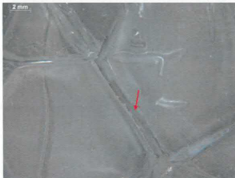
Figuur 5.9: Ruit 5. Stereomicroscopische foto van het centrale breukvlak in het vlinderpatroon met de locatie van het insluitel
