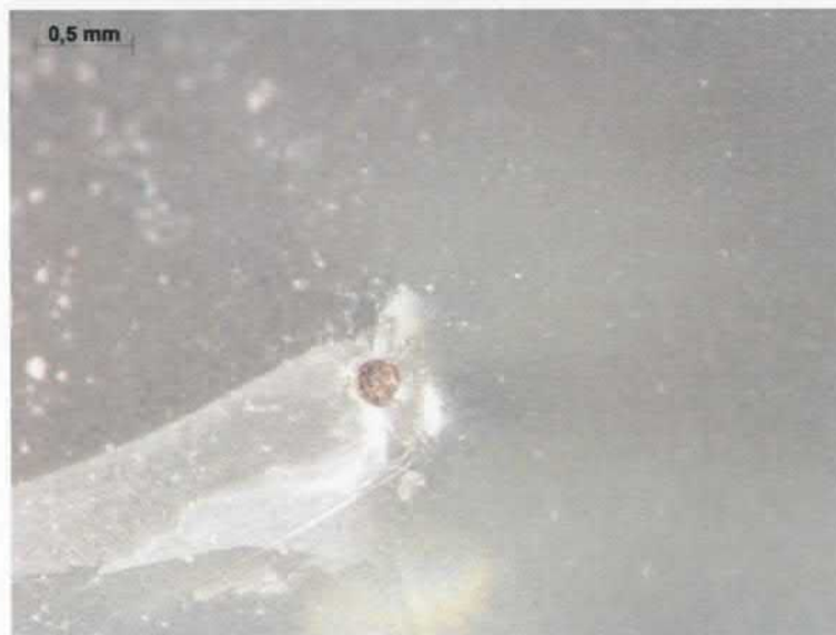
Figuur 5.5: Ruit 4. Vlinderpatroon; de rode pijl geeft het breukvlak met insluitel aan
