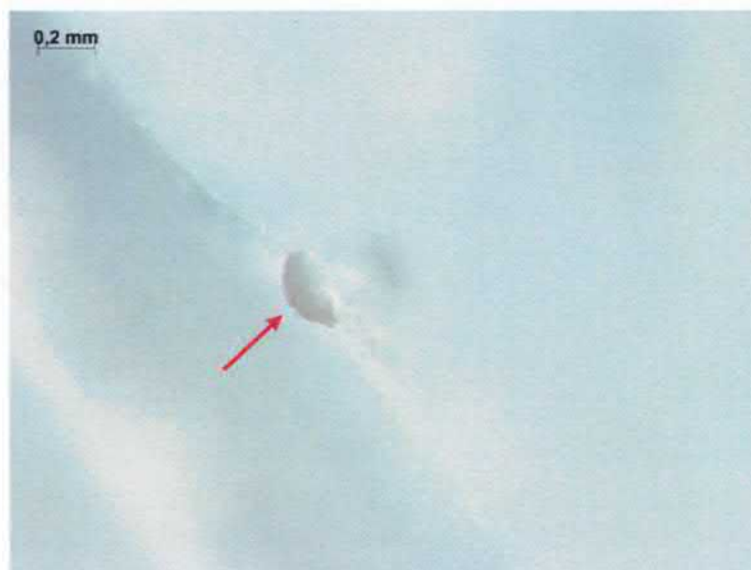
Figuur 5.10: Ruit 5. Stereomicroscopische foto van insluitel op breukvlak
