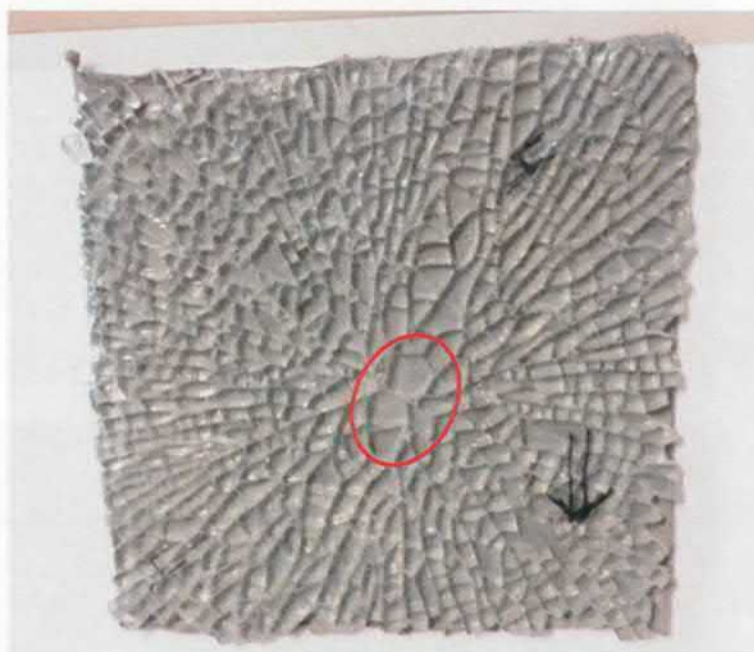
Figuur 5.4: Ruit 4. Vlinderpatroon centraal in het monster
