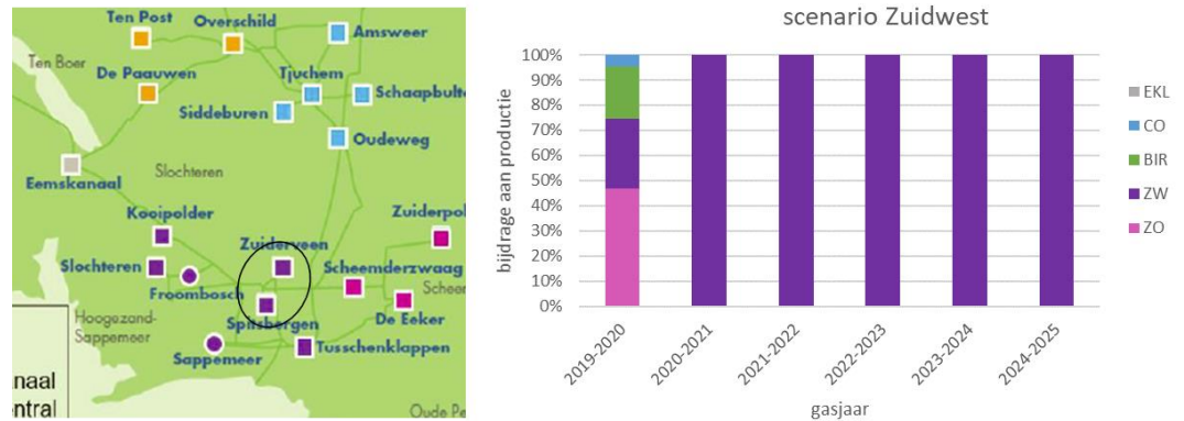
Figuur 11. Relatieve productie verdeling van scenario Zuidwest. De producerend clusters (vanaf gasjaar 2020-2021) voor dit scenario zijn omcirkeld.
