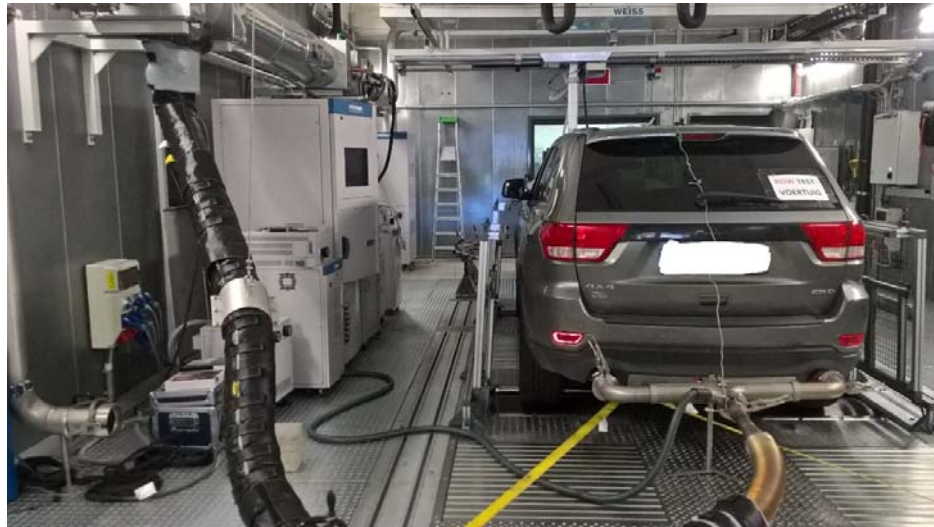
Figuur 3-1: Rollenbank en meetapparatuur voor het uitvoeren van een emissietest.
