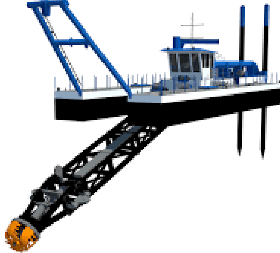
Figuur 23: Voorbeeld Cutterzuiger
