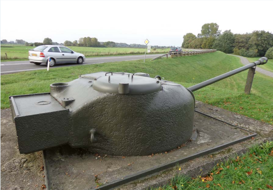
Koepel van een M4 Sherman tank ingegraven en hergebruikt in jaren '50 als bunkergeschut in de IJssellinie, nabij Olst. Foto: Commons Wikimedia.
