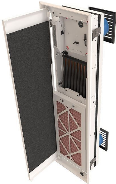
Figuur B4.1: Principe van een zeer energie-efficiënte, CO 2 -gestuurde decentrale ventilatie-unit van Fresh-r, inclusief warmtewisselaar, twee ventilatoren en twee roosters aan de achterkant, die in de gevel worden aangebracht [bron: https://fresh-r.eu ].
