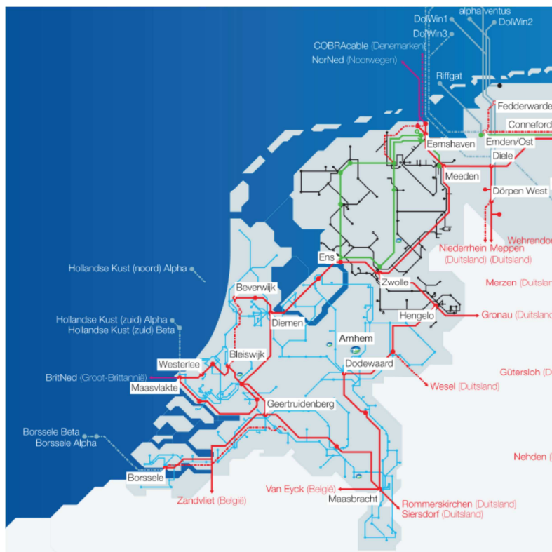
Figuur 4.18 – Transmissienetwerk en interconnectoren (Bron: TenneT)
