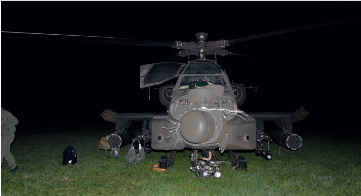
Figuur 9: Resten van de hoogspanningsdraden (bliksemdraden) op de M-TADS en het landingsgestel van de helikopter. (Bron: Onderzoeksraad voor Veiligheid)
