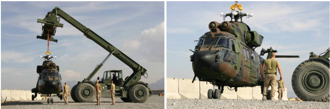
Figuur 5 - voorbereiding voor underslung transport
