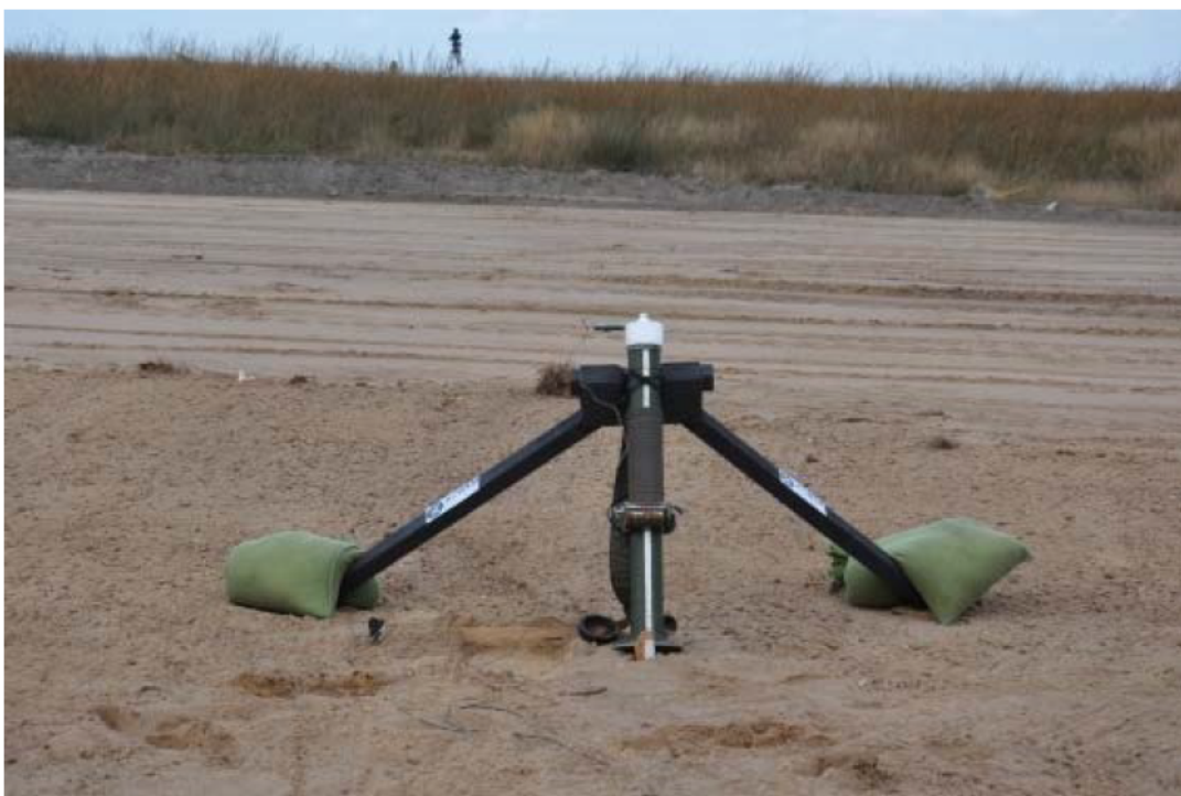
14 opstelling mortier met geplaatste pyrotechnische pin in ontstek
