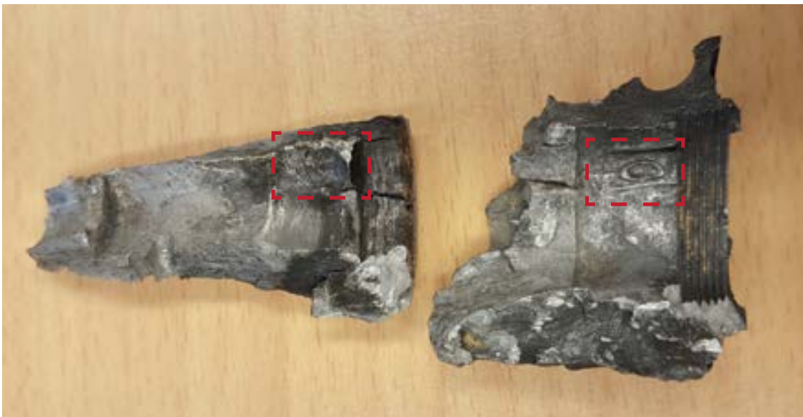
Figuur 10: Afdruk van de sluiters en sluiterveer op de binnenwand van de geteste schokbuis in de gewapende stand (links) en op de binnenwand van de schokbuis van de ongevalsgranaat (rechts). (Foto's: TNO)
