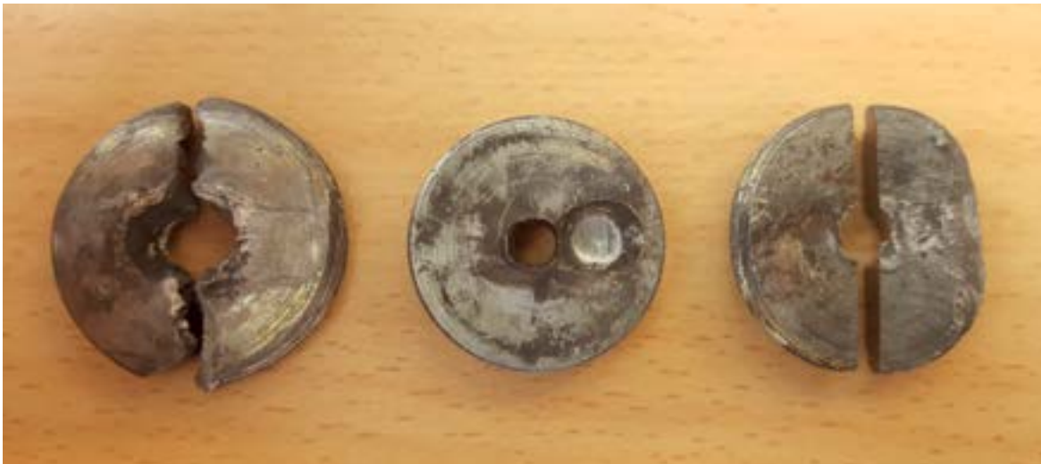
Figuur 14: Verschillende aanzichten van de bovenzijde van een afsluitplaat. Links de bovenzijde van de afsluitplaat uit de test in gewapende stand, in het midden een afsluitplaat uit de test in ongewapende stand en rechts de afsluitplaat uit het ongeval. De afsluitplaat uit de ongevalsgranaat is intact teruggevonden, maar is doorgezaagd voor nader onderzoek. (Foto: TNO)
