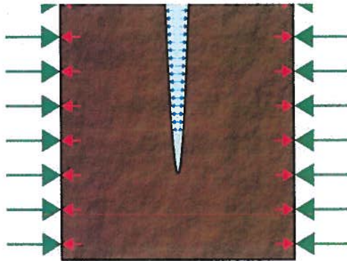
Figuur 9: Het openen van een "frac" gebeurt wanneer de vloeistofdruk (blauw) groter is dan de spanning die de frac dichtduwt. De spanning bestaat uit een geologische component (groen) en een thermische component (rood). Bij de injectie van koude vloeistof zorgt de thermische component voor een afname van de heersende spanning, waardoor fracs makkelijker ontstaan.
