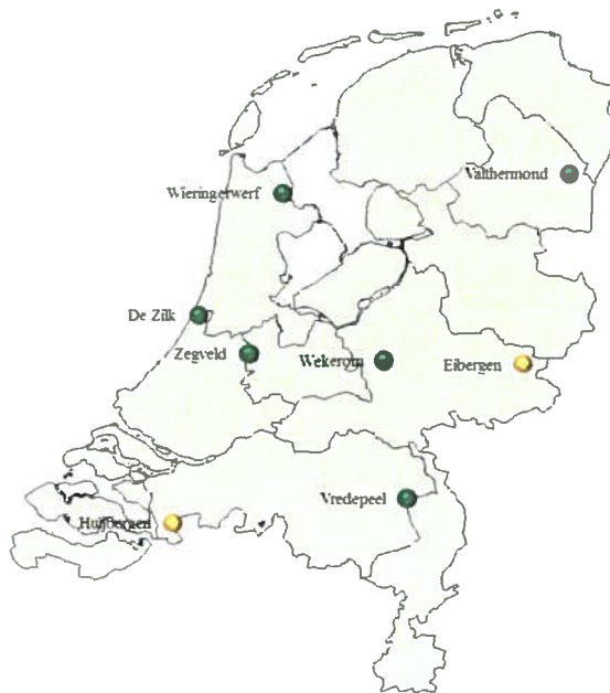
Figuur 2a. Meetpunten van de uurlijkse ammoniakconcentratie in de buitenlucht uitgevoerd met automatische monitoren in het LML. In geel de meetpunten waar tot 2014 werd gemeten. Op deze locaties zijn de metingen van ammoniak voortgezet met passieve samplers zoals gebruikt in het MAN.
