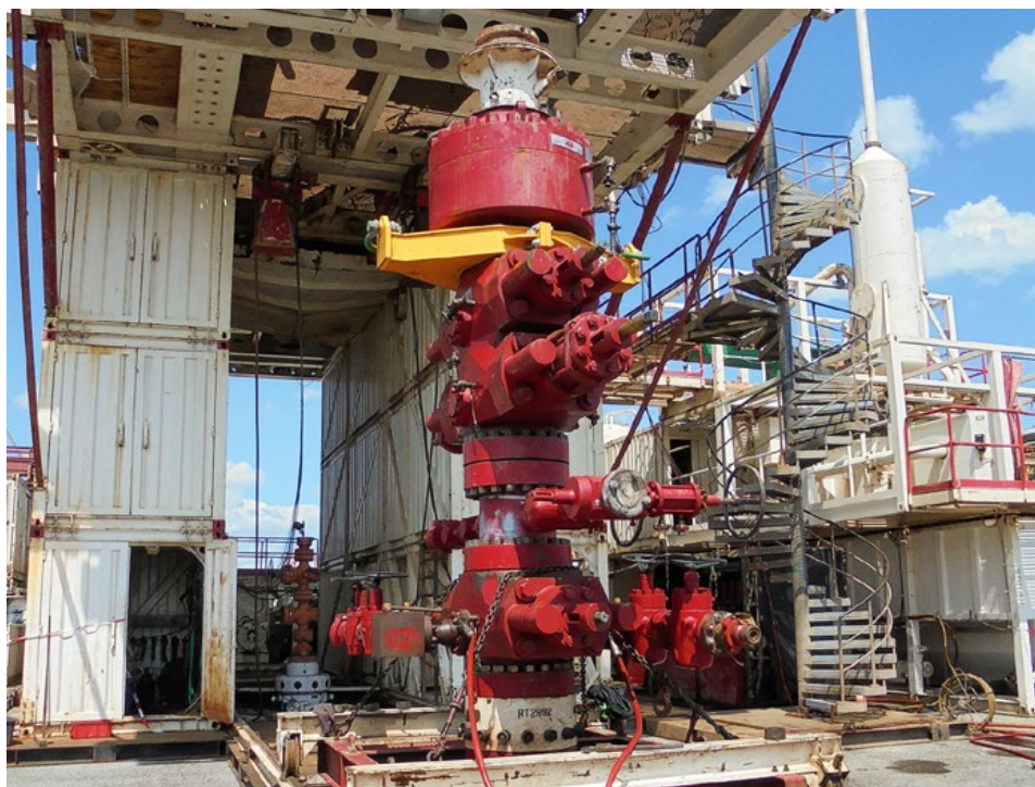
Test frame met BOP
