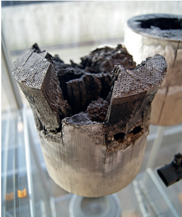
Figuur 7. Een volledig verwoest roefilter. Doorrijden met een verzadigd roefilter kan het roefilter onherstelbaar beschadigen en zelfs ernstige motorschade veroorzaken (foto: TNO bij Digicar Engineering).
