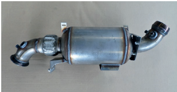
Figuur 1. Een roetfilter van een personenwagen, als onderdeel van het uitlaatsysteem. Het filterelement (zie Figuur 2) bevindt zich in de metalen behuizing (foto: Topcats).
