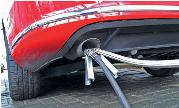
Figuur 13. De roeuitstoot van dieselvoertuigen kan tijdens de APK worden vastgesteld met behulp van een rookmeter. Voor moderne dieselauto's mag men echter volstaan met het uitlezen van het OBD-systeem (foto: TNO).
