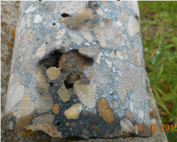
Afbeelding 1.3. Luchtinsluitingen kern X8-onder
