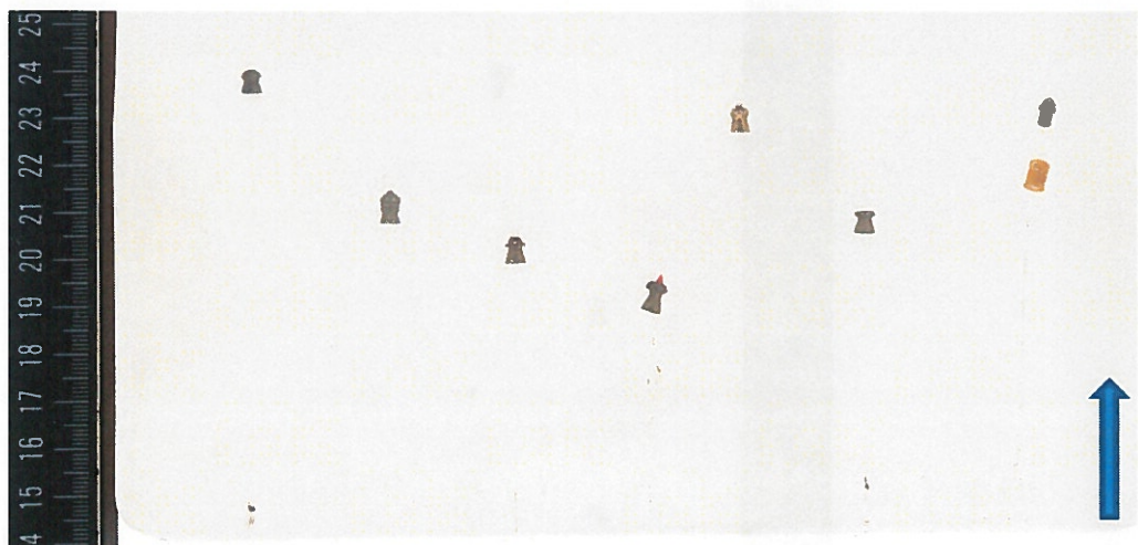
Foto 9 4,5 mm projectielen in gelatine met v.l.n.r.: JSB Exact RS, H&N Silverpoint, H&N Hollow Point, Predator Polymag, Gamo Platinum, JSB Match Diabolo, Prometheus. De pijl geeft de schietsrichting aan.
