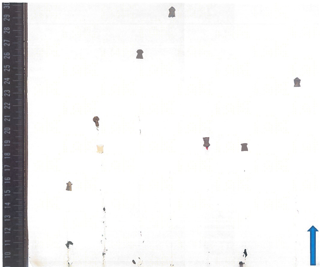
Foto 11 5,5 mm projectielen in gelatine met v.l.n.r.: Champion Tiger Silver, Prometheus Truncated, JSB Diabolo Exact, H&N Baracuda, Predator Polymag, Umarex Classic, H&N Silverpoint. De pijl geeft de schietsrichting aan.
