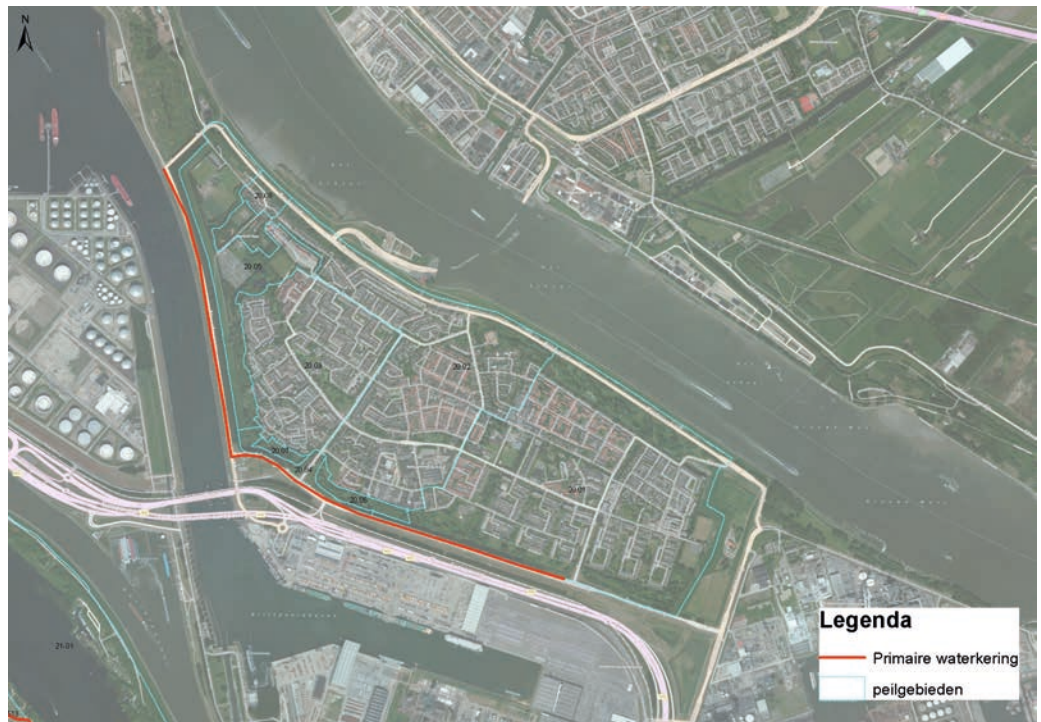
Afbeelding 51 Waterkering in de omgeving van de Calandbrug
